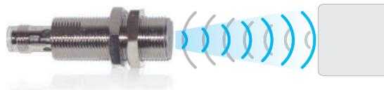
Le détecteur à ultrasons XXV est "Plug and Play" : pas de réglage, pas d'apprentissage. Sa sortie statique change d'état dès que l'objet à détecter est à moins de 50 mm.
