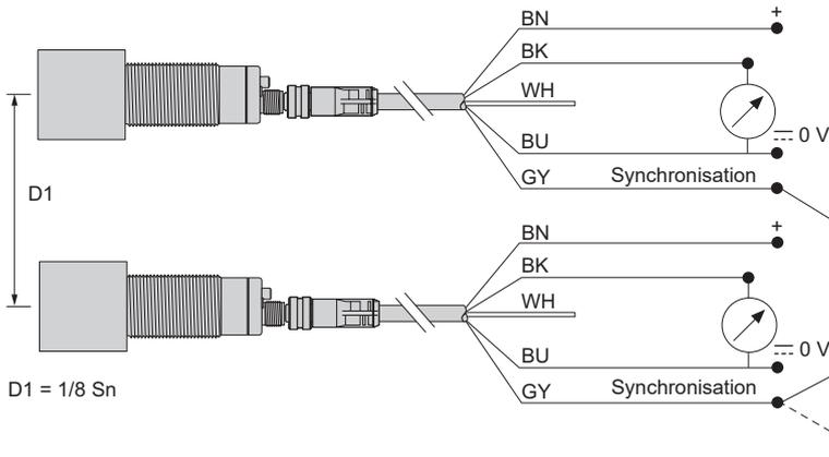
**Nota :** pour permettre la synchronisation entre plusieurs détecteurs, tous les fils du contact n° 5 (gris) doivent reliés électriquement ensemble. Un maximum de 8 détecteurs peuvent être synchronisés. Pour permettre la fonction "multiplexeur" pour les détecteurs, utiliser le logiciel de configuration XX. Sans synchronisation ou multiplexage, les détecteurs doivent être espacés d'au moins 50 cm afin d'éviter toute interférence mutuelle.
