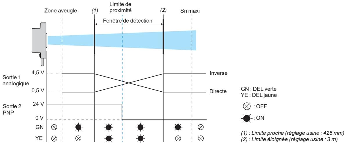
Nota : La sortie analogique du détecteur émet 5 volts lorsqu'il détecte un bruit ambiant excessif.
