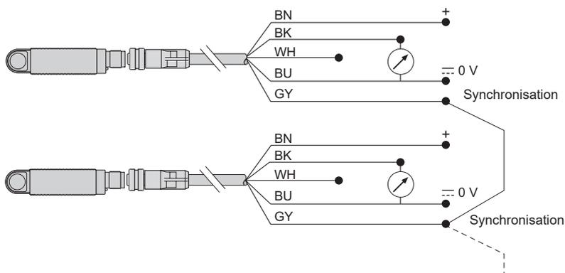
**Nota :** pour permettre la synchronisation entre plusieurs détecteurs, tous les fils du contact n° 5 (gris) doivent être reliés électriquement ensemble. Un maximum de 8 détecteurs peuvent être synchronisés. Pour permettre la fonction "multiplexeur" pour les détecteurs, utiliser le logiciel de configuration XX. Sans synchronisation ou multiplexage, les détecteurs doivent être espacés d'au moins 50 cm afin d'éviter toute interférence mutuelle.
