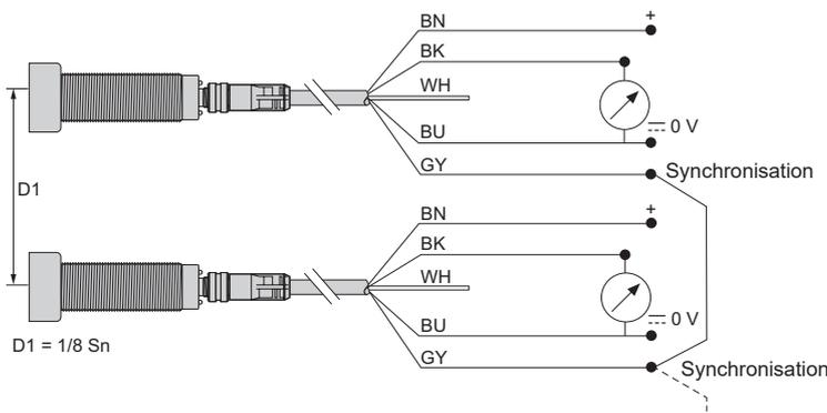
**Nota :** pour permettre la synchronisation entre plusieurs détecteurs, tous les fils du contact n° 5 (gris) doivent être reliés électriquement ensemble.
