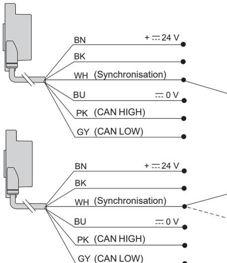
**Nota :** La synchronisation est recommandée si plus d'un détecteur est utilisé dans le même sens afin d'éviter toute interférence entre les détecteurs du fait de leur largeur de faisceau. Jusqu'à 8 détecteurs peuvent être synchronisés pour fonctionner côte à côte en connectant électriquement tous les fils de la broche n° 4 (blanc) ensemble. Tous les détecteurs doivent être du même modèle et avoir le même réglage de temps de cycle.
