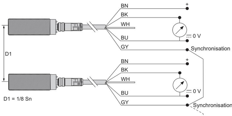
**Nota :** pour permettre la synchronisation entre plusieurs détecteurs, tous les fils du contact n° 5 (gris) doivent reliés électriquement ensemble. Un maximum de 8 détecteurs peuvent être synchronisés. Pour permettre la fonction "multiplexeur" pour les détecteurs, utiliser le logiciel de configuration XX. Sans synchronisation ou multiplexage, les détecteurs doivent être espacés d'au moins 50 cm afin d'éviter toute interférence mutuelle.
