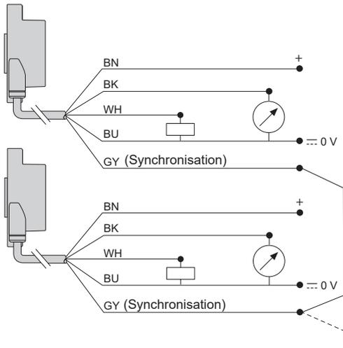
**Nota :** La synchronisation est recommandée si plus d'un détecteur est utilisé dans le même sens afin d'éviter toute interférence entre les détecteurs du fait de leur largeur de faisceau. Jusqu'à 8 détecteurs peuvent être synchronisés pour fonctionner côte à côte en connectant électriquement tous les fils de la broche n° 6 (gris) ensemble. Tous les détecteurs doivent être du même modèle et avoir le même réglage de temps de cycle.
