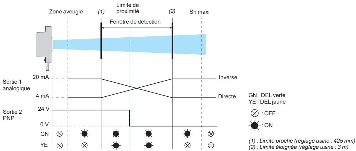
Nota : La sortie analogique du détecteur émet 2 mA lorsqu'il détecte un bruit ambiant excessif.
